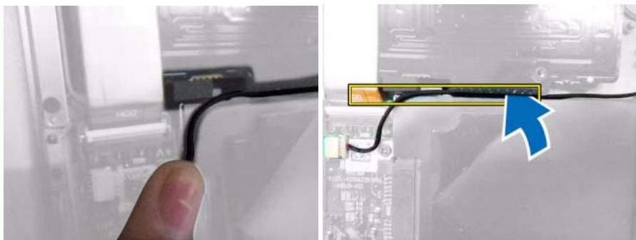
**7** Attaccare il nastro biadesivo sul cavo e sulla protezione in gomma in modo che il cavo sia fissato.
