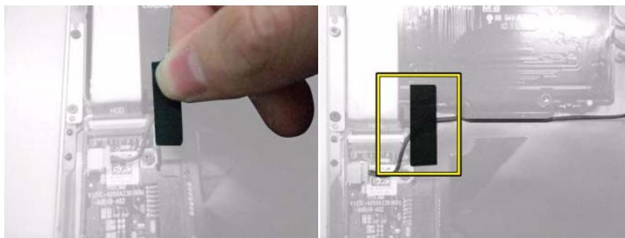
**8** Con delicatezza, staccare il nastro biadesivo dal cavo flessibile del disco rigido di sostituzione.
